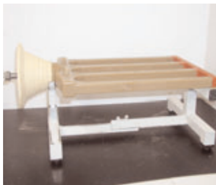
Ein Ergebnis des kontinuierlichen Verbesserungsprozesses (KVP): Statt wackeligen Holzkisten benutzen die Mitarbeiter bei FEINGUSS BLANK heute variable Metallrahmen bei der Herstellung von Gussformen. So wurde der Ausschussanteil gesenkt und der Arbeitsablauf stabilisiert.
